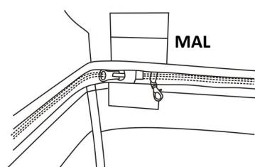
7. Acople los tubos insertándos entre si mediante los extremos.
