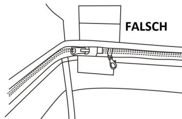
7. Verbinden Sie die Rohren, indem Sie sie in die Einlage einführen.
